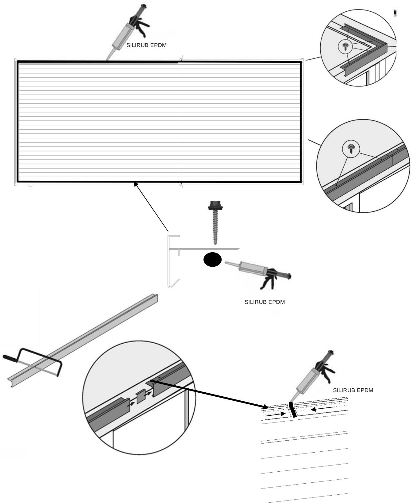
Snj de extra EPDM over de kanten weg met behulp van een mes, zonder de waterdichting daarmee in gevaar te brengen. Eliminez les feuilles EPDM extras sur le contour du toit en utilisant un couteau, sans déteriorer le colmatage de l'eau.
