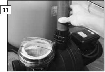
11 Draai de verbindingsstukken in de filter en in de pomp. Schuif de fittingen en daarna de inlegstukken over de beide uiteinden van de slang. Breng de inlegstukken terug in het verbindingsstuk en draai uiteindelijk de fittingen vast. (zie technisch gedeelte: 2.4.3 Aansluitingen)
