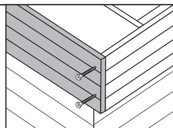
Installez les lattes de finition à l'avant et à l'arrière.
