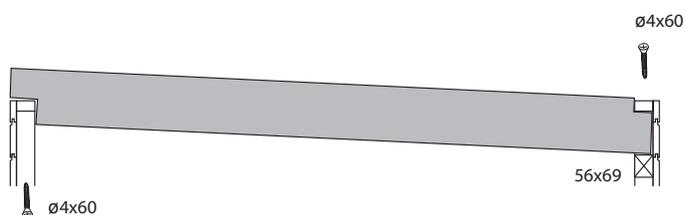
Mettez un côté de la barre transversale (58x170mm) sur la façade et l'autre côté sous la dernière latte de la paroi arrière. Un support horizontal (56x69) a été prévu.
