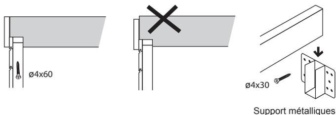
Les solives sont en deux ou plusieurs parties. A l'extérieur elles sont installées sur les parois et sur la barre transversale à l'aide des supports métalliques (32x95).
