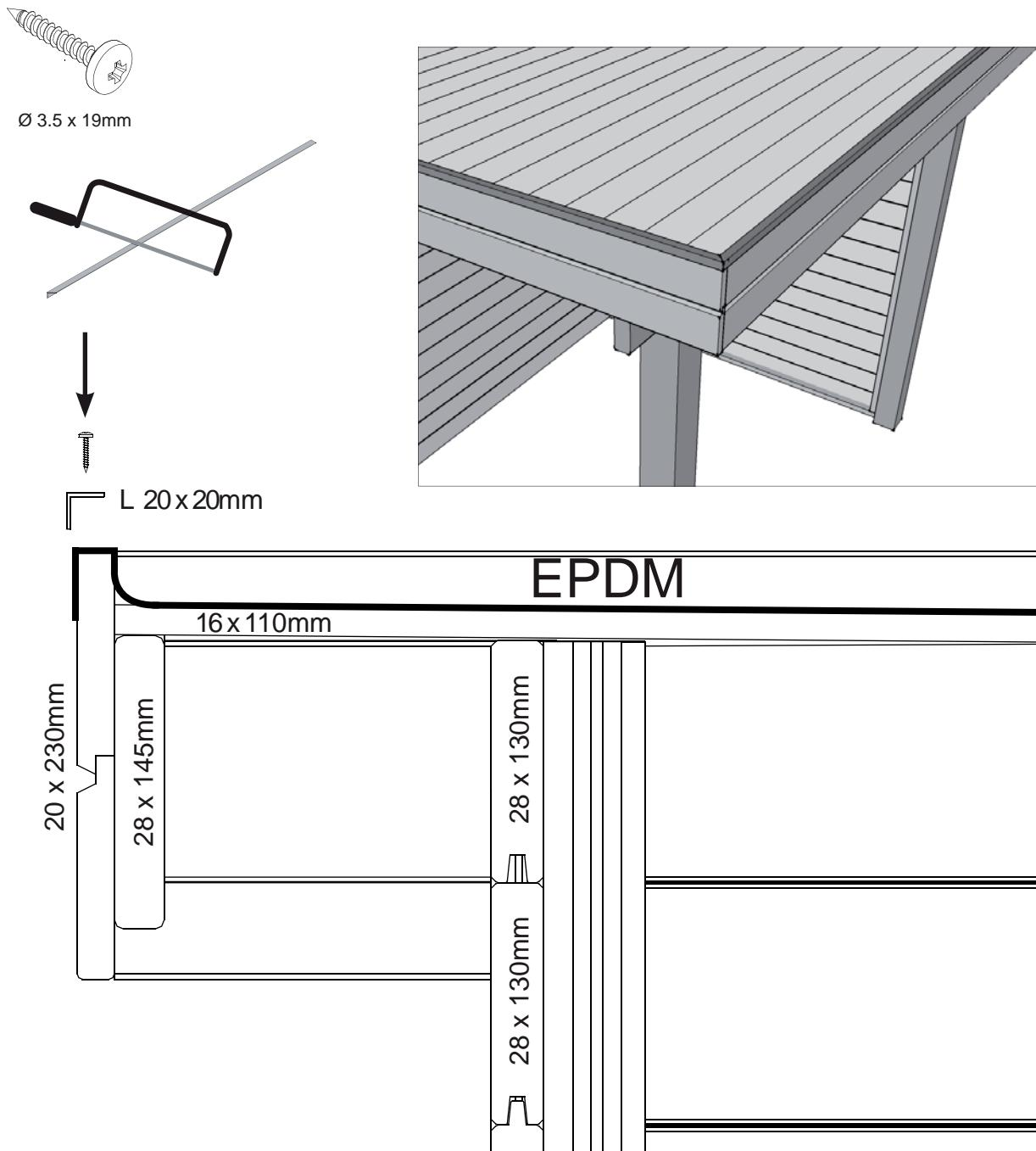
Snij de extra EPDM over de kanten weg met behulp van een mes, zonder de waterdichting daarmee in gevaar te brengen.
