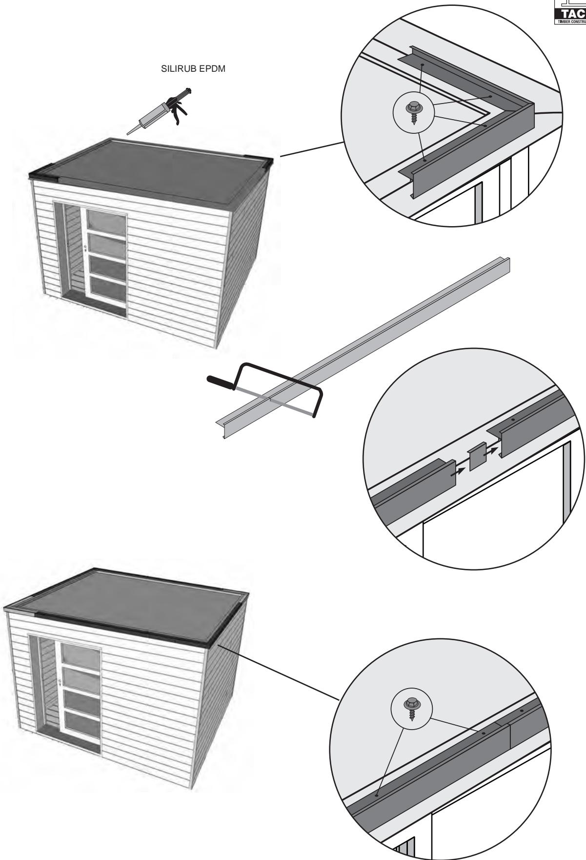
Snij de extra EPDM over de kanten weg met behulp van een mes, zonder de waterdichting daarmee in gevaar te brengen.
