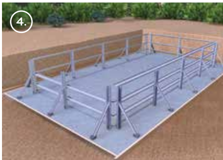
4. Plaatsing van de panelen (vastklikken + revetteren)
