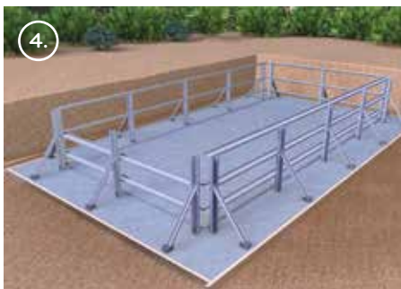
4. Poser les panneaux (cliquer + revetter)
