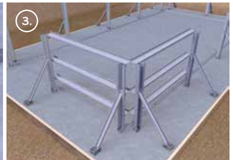
3. Monter la structure métallique
